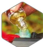
Tanque de aceite para lubricación de cadenas
